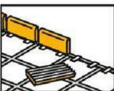
Nyní lepidlo naneste na zadní stranu soklu a ten přiložte na stěnu tak, aby spáry byly v jedné rovině. Pro dodržení odstupu spár jej podložte dřevěnou destičkou.
