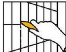
Spárovací hmota gumovou stěrkou nebo pěnovým hladitkem úhlopríčně zaprávte přes plochu dlažby a do spár. Hmota musí být vpravena bez dutin.
