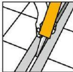
U všech přechodů mezi místnostmi a na místech, kde už v potahu jsou dilatační spáry, musíte zabudovat dilatační spáry. Nesmí však dojít ke kontaktu dilatační spáry s nátěrem. Nejjednodušší metodou je do spáry vtlačit pěnový profil a nastříkat na něj elasticou spárovací hmotu. Touto metodou si navíc můžete ušetřit spárovací hmotu. Spáry by mely být minimálně 8 mm hluboké a široké.
