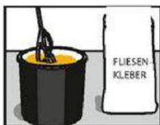
Lepidlo na dlaždice namíchejte pomocí mláchadla (použijte nízkootáčkovou vrtačku). Měla by vzniknout homogenní hmota.
