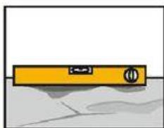
Podklad musí být vždy nosný, bez trhlin, čistý a rovný. Nerovnosti do 5 mm lze vyrovnat použitím lepidla na dlaždice a větší nerovnosti, po penetraci, pomocí nivelační hmoty.
