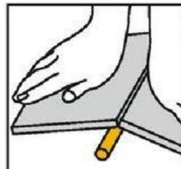
K častým úkonům při pokládce dlažby a obkládání stěn patří přírezávání. Proto se opravdu vyplatí pořídit si řezačku na dlaždice. Dlaždice se do řezačky vloží tak, aby ste na potřebné místě povrchu dlaždice mohli provést naříznutí. Řezačky na dlaždice mají běžně i štipačku. Dlaždici můžete hladce odštipnout i nad podloženou hranou.
