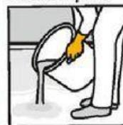
Fluidní lepidlo je rovněž vyrobeno na bázi cementového lepidla. Jeho hlavní oblast použití představují velké a rovné podlahové plochy. Lepidlo rozmete na hustou tekutou hmotu a po oblépení okrajů jej nalijte přímo na podklad.
