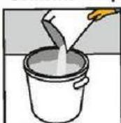
Cementová lepidla je třeba krátce před použitím rozmíchat s vodou a vytvořit z nich hmotu. Do stanoveného množství vody nasypte prášek a danou směs zpracujte pomocí mléchadla na homogenní hmotu. Po uplynutí předepsané „doby zrání“ hmotu opětovně promíchejte.
