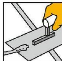
U velkých nejednotných rozestupů mezi spárami a obkladů s neglazovaným materiélem používáme fluidní spáru. Ta se po namícheání nalije do spáry, a po asi 30 až 45 minutách můžete z povrchu dlaždic přebytečnou hmotu snadno a lehce odstranit.
