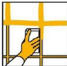
Nehezké spáry můžete obnovit pomocí spárovací barvy. Staré spáry očistěte čisticím prostředkem, a houbičkou nebo štětcem naněte spárovací barvu na spáry. Po částečném zaschnutí (spáry se matně lesknou) přebytečnou spárovací barvu na okrajích dlaždic setřete navlhčenou houbičkou.
